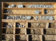
profil jadra 739-845m tektonické porušenie, vyplnené tektonickým ílom, brekciovitá, rozpadavá, svetlosivá, vápence silne prerastené sieťou kalciových žíl
