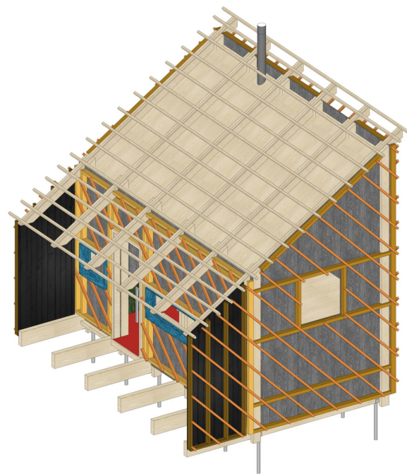
KROK 3 - inštalovanie lát pre fasádne dosky - pod 45° uhlom, bez potreby robiť dvojité rošty
